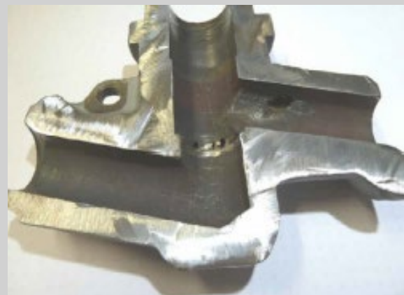
2 Totalausfall der Absperrarmatur durch Ausstrahlung am Austritt | Complete shut-off valve failure caused by discharge at the outlet
