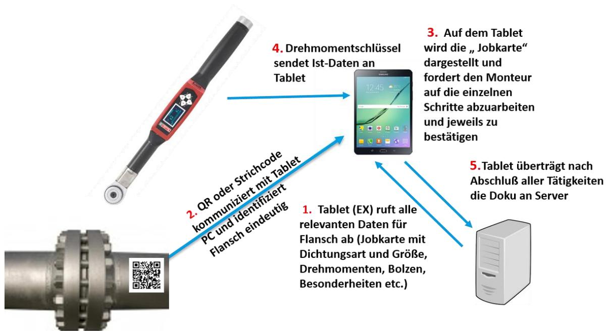
Abbildung 9: Beispiel II – Digitale Flansch. © Weber Rohrleitungsbau
